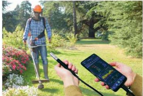
Une fois les mesures terminées, le logiciel ATomic Viewer (Visualisation) permet de relire les résultats et facilite la rédaction des rapports. ATomic-1 est également compatible avec d'autres logiciels (Matlab, Labview, Python, etc.).
